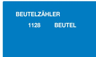
2. Um den Zähler auf Null zurückzusetzen, drücken Sie die PLUS (+) und MINUS (-) Tasten fünf Sekunden lang, bis in der Anzeige folgendes erscheint:
